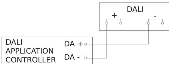
Schéma de câblage pour la mise en réseau DALI-2 APC & DALI-2 IPD
